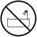
Verwenden Sie dieses Gerät nicht in der Nähe von mit Wasser gefüllten Badewannen, Waschbecken oder sonstigen Behältern. Das Gerät darf nicht im Nahbereich von Badewannen oder Duschen montiert werden.
